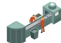
Infine, il materiale giunge a una **seconda stazione di cernita manuale** per la rimozione di ulteriori corpi estranei, non idonei o non conformi, e viene sottoposto a **un'ultima vagliatura e frantumazione** su nastro mobile vibrante.
