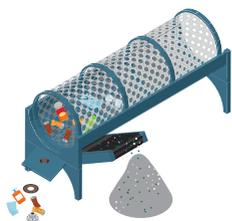
Per prima cosa, vengono inviati ad una grande **griglia vibrante** (oppure, in base al tipo di impianto, ad un **mulino a cilindri**) e, successivamente, vengono inviati ad un **vibrovaglio**. Lo scopo è duplice:
