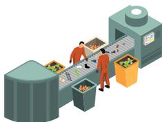
Una volta giunto presso l'impianto di selezione, il materiale viene **suddiviso per tipologia e depurato da materiali estranei**, sia con azione meccanica sia manuale. Queste operazioni ne facilitano il riciclo.
