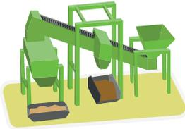
Il rifiuto organico viene sottoposto a una prima **fase di preselezione e selezione**, in modo da **rompere i sacchi compostabili ed eliminare impurità e materiale non conforme**.
