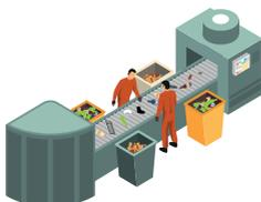
Nell'impianto di trattamento, il materiale effettua un **preliminare passaggio di cernita** attraverso **tramogge** e **nastri**, viene separato da eventuali sacchi di contenimento e viene pulito e depurato dal materiale non conforme anche con **azione manuale**.
